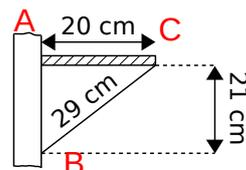
**Exercice** Pour vérifier s'il a bien posé une étagère de 20 cm de profondeur sur un mur parfaitement vertical, M. Brico a pris les mesures marquées sur le schéma ci-contre. Son étagère est-elle parfaitement horizontale ?
